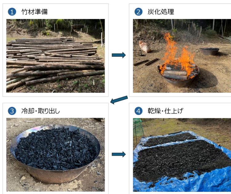
Fig. 3-1. 無煙炭化器で廃竹からの竹炭作り
