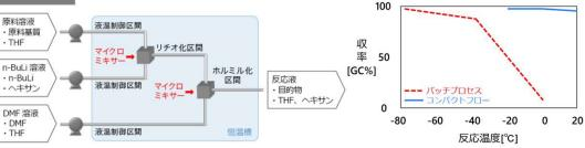
Coflore® の活用 付加体形成では、目的物が析出するため一般的なフロー反応では流路閉塞により運転困難です。
